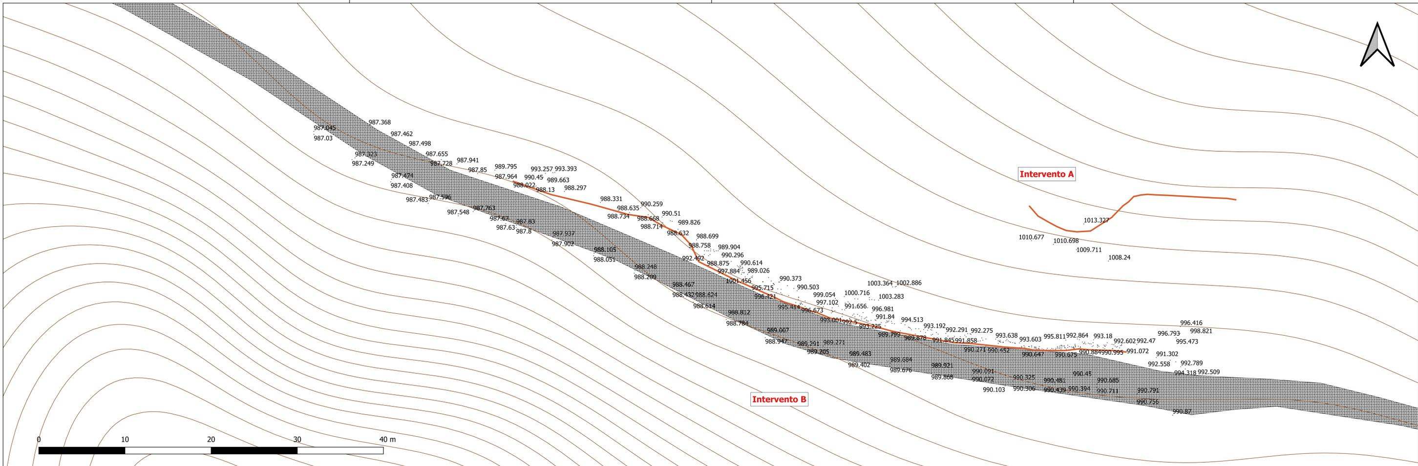
Rilievo topografico di dettaglio per punti integrato con basedati (DTB) della Regione Lombardia
